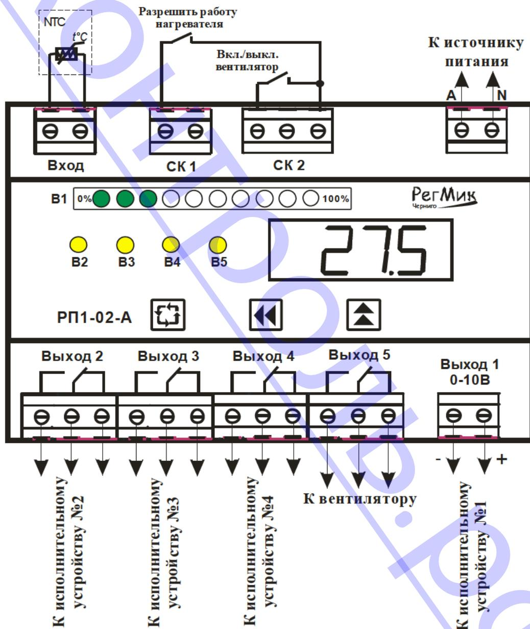
Рисунок 5 – Схема подключения прибора
