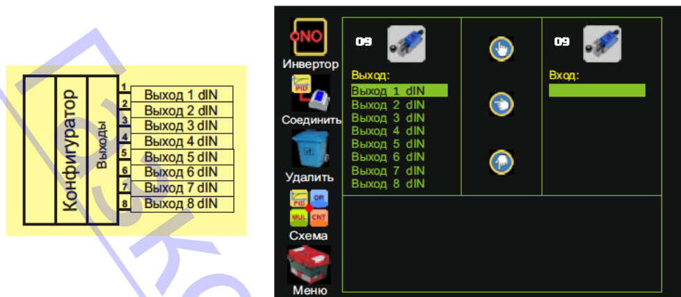
Рис. 27. Выходы функционального блока "Дискретный ввод"
