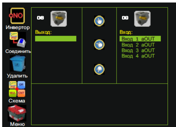
Рис. 30. Входы функционального блока "Аналоговый вывод"
