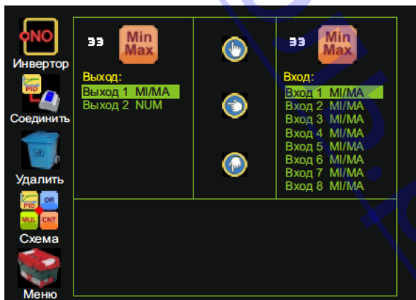
Рис. 115. Входы и выходы функционального блока “Минимум-Максимум” на экране контроллера
