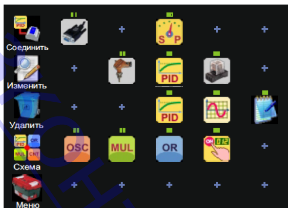
Рис. 11. Схема с выбранным блоком "Регулятор" (подчеркнут белой пунктирной линией)
