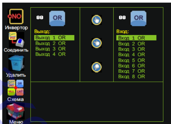
Рис. 67. Входы и выходы блока “Логическое ИЛИ” на экране контроллера
