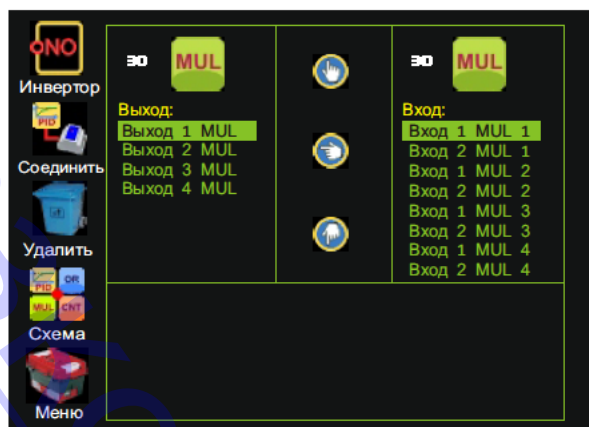
Рис. 37. Входы и выходы блока “Умножение” на экране контроллера
