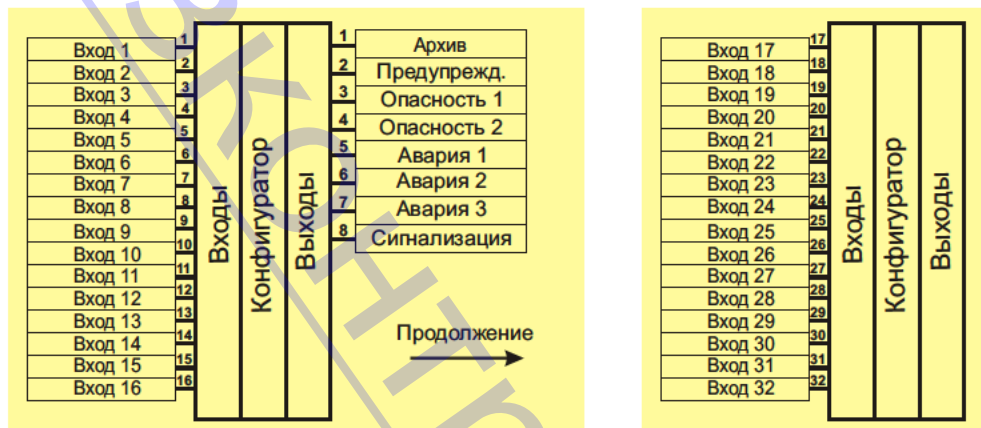
Рис. 145. Структура функционального блока "Журнал"
