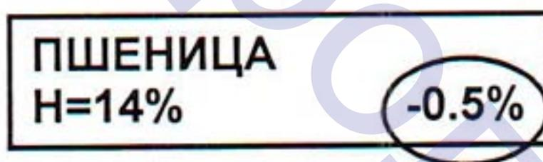
Кнопками ← , → установите желаемую поправку. Одновременно с внесением поправки слева меняется значение влажности, уже скорректированное. Установив желаемое значение, коротко жмите «Ввод», и значение поправки исчезнет с дисплея. Форма калибровочной кривой при внесении поправки не изменяется. Происходит только параллельный перенос характеристики «вниз» -«вверх». Поправка для каждого из 99 каналов своя и независима. Пределы регулировки + - 5% с шагом 0,1%.
